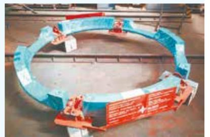
Опорное кольцо изготавливается из легированной хромомолибденовой стали перлитного класса. При этом по периметру кольца выполняются две двухслойные аустенитные наплавки для выполнения сварных соединений с баком. Диаметр изделия составляет 3,25 метра, масса – 2,5 тонны.
